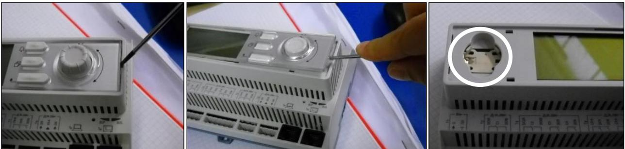
Следует избегать повреждения пластмассовой крышки. Новая батарея устанавливается в соответствующий отсек (см. обозначение на рисунке) с соблюдением полярности, указанной внутри отсека.
