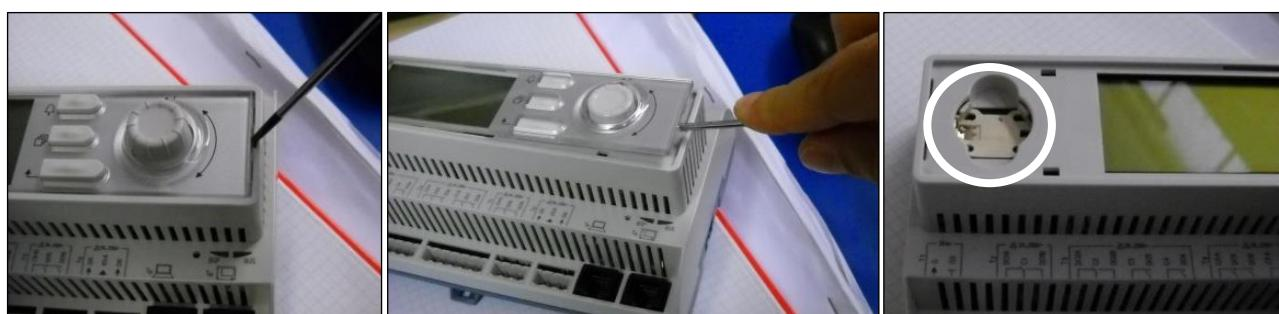
Pazite da ne oštetite plastični poklopac. Nova baterija mora se staviti u odgovarajući držač baterije koji je istaknut na sljedećoj slici, poštujući polaritet navedene u samom držaču.
