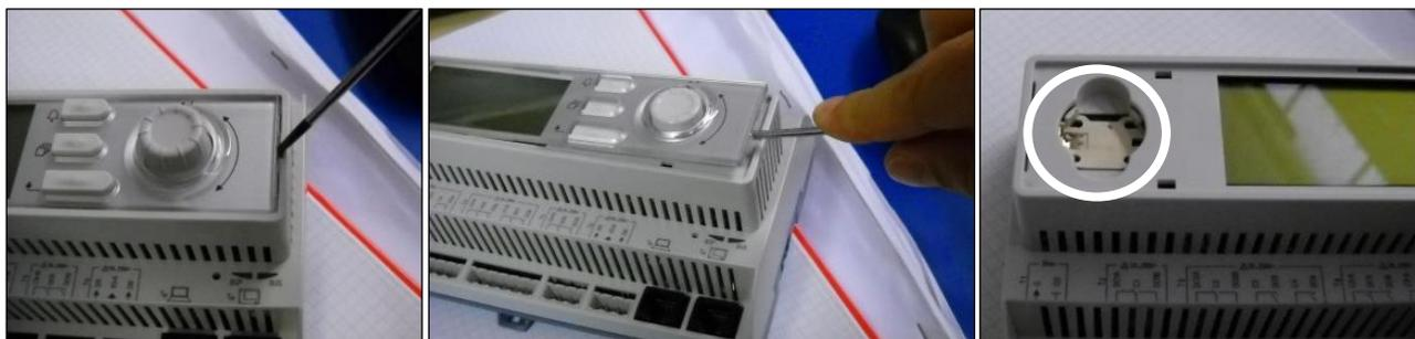
Tenha cuidado para evitar danos à cobertura de plástico. A nova bateria deve ser colocada no suporte apropriado da bateria, destacado na figura, respeitando as polaridades indicadas no próprio suporte.
