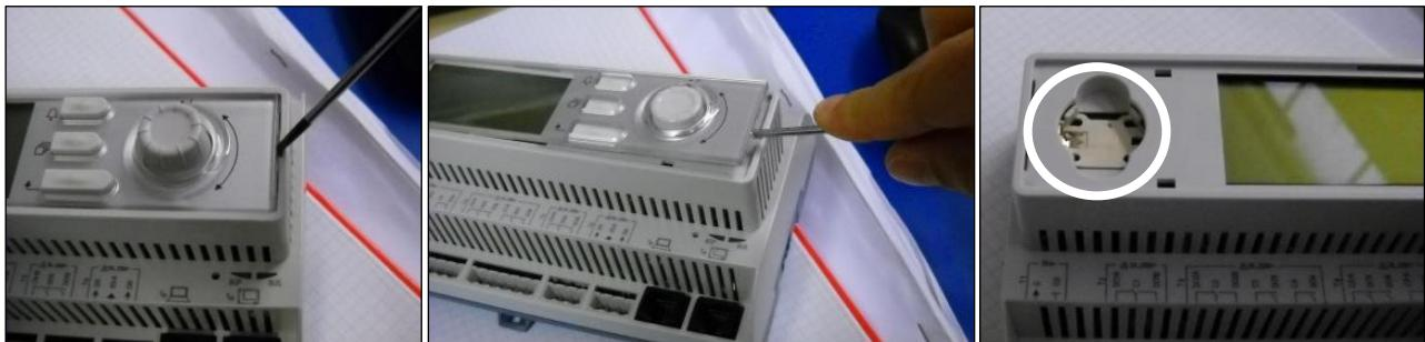
Dejte pozor, abyste plastový kryt nepoškodili. Novou baterii je třeba vložit do správného držáku, který je na obrázku zvýrazněný, a je třeba respektovat polarity vyznačené na samotném držáku.
