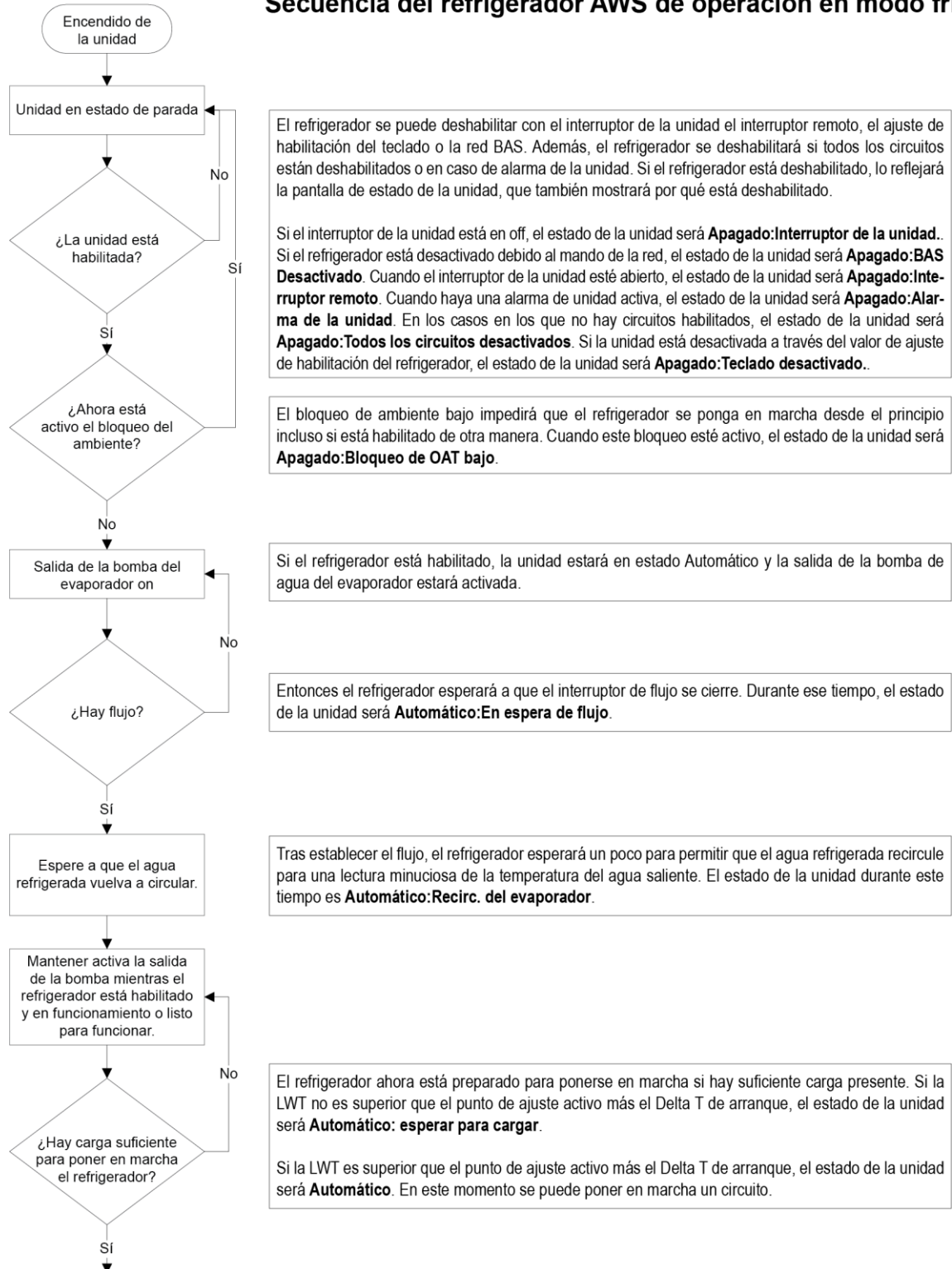
Figura 5, Secuencia de operación de la unidad (consulte la Figura 9 para ver la secuencia de operación del circuito )
