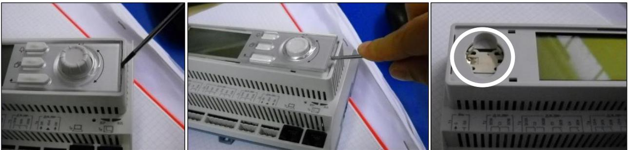
Seien Sie vorsichtig, damit die Kunststoffabdeckung nicht beschädigt wird. Dann die neue Batterie ordnungsgemäß in die Halterung (siehe markierter Bereich auf der nachfolgenden Abbildung) einsetzen und dabei auf die richtige, in der Halterung gekennzeichnete Polarität achten.
