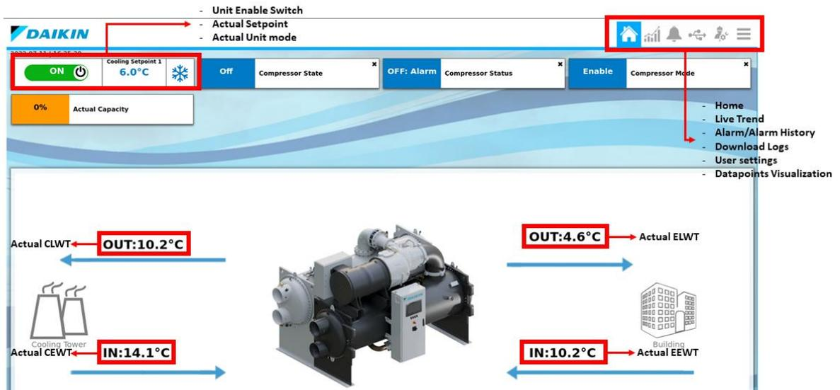
Die OITS-Anwendung ist für den Austausch von Echtzeitdaten mit dem MicroTech-Controller ausgelegt. Stellen Sie sicher, dass der Monitor über ein Ethernet-Kabel mit der SPS verbunden ist, damit die SPS-Daten korrekt angezeigt werden.
