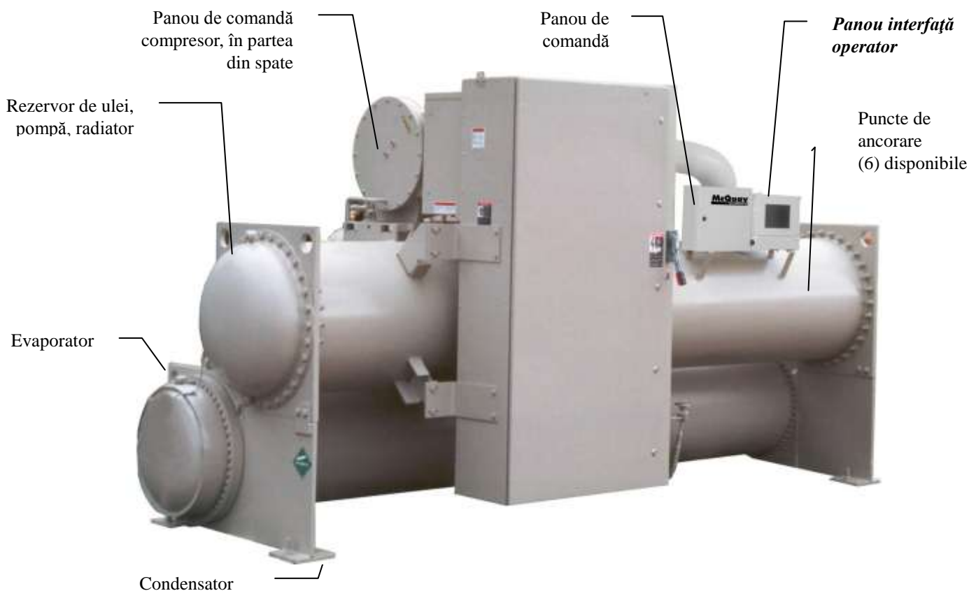
Figura 1, Dispunerea componentelor principale ale unității DWSC
