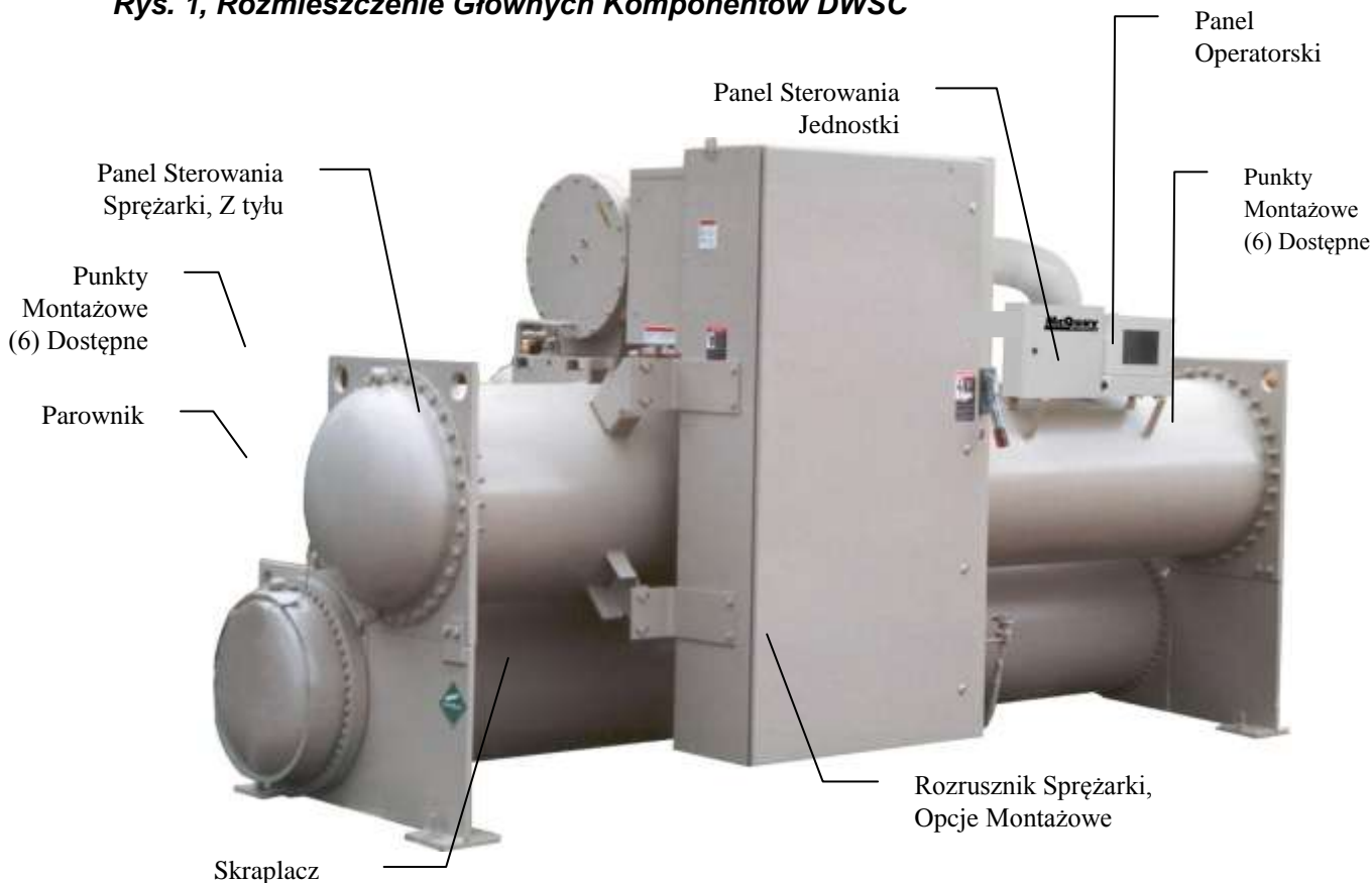
Rys. 1, Rozmieszczenie Głównych Komponentów DWSC
