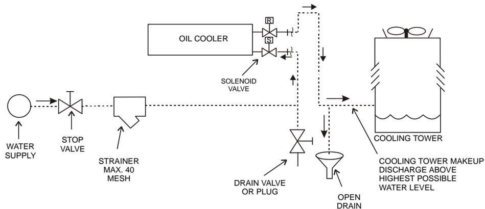
**Fig.° 11- DWSC, collegamenti di raffreddamento dell'olio**
