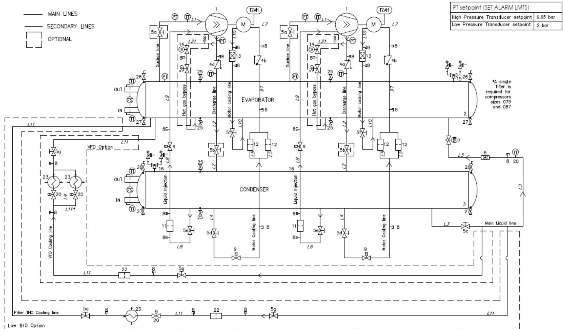
**Fig.° 2- Circuito dell'olio standard**
