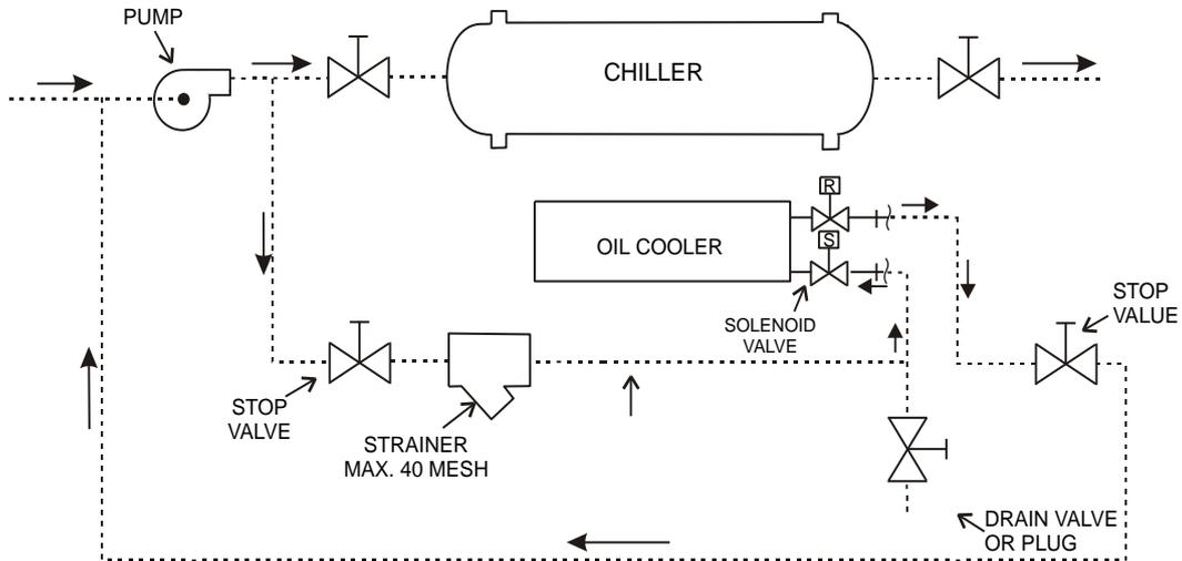
**Fig.° 10- Tubazioni del raffreddatore dell'olio con acqua domestica**
