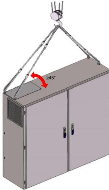
Per la movimentazione con gru o gru a ponte, prima di sollevare il pannello è necessario verificare le seguenti condizioni:
