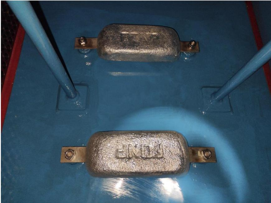
**ATTENZIONE:** se alla prima ispezione (dopo un mese) il consumo dell'anodo risulta eccessivo, significa che l'ambiente è eccessivamente aggressivo quindi è necessario rivedere il piano per garantire delle corrette condizioni di funzionamento. E' consigliato sostituire gli anodi se il loro spessore è inferiore a 15mm.
