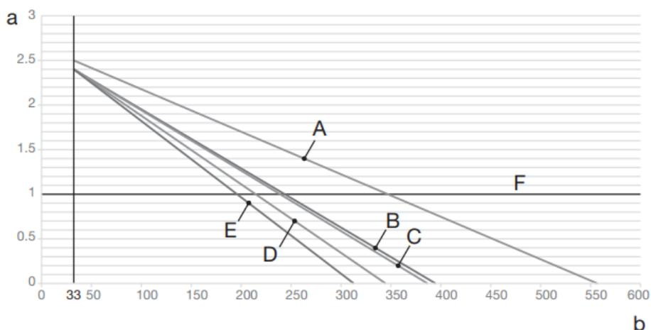
**Figura 15 - Pressione iniziale del serbatoio di espansione in base al volume massimo dell'acqua**
