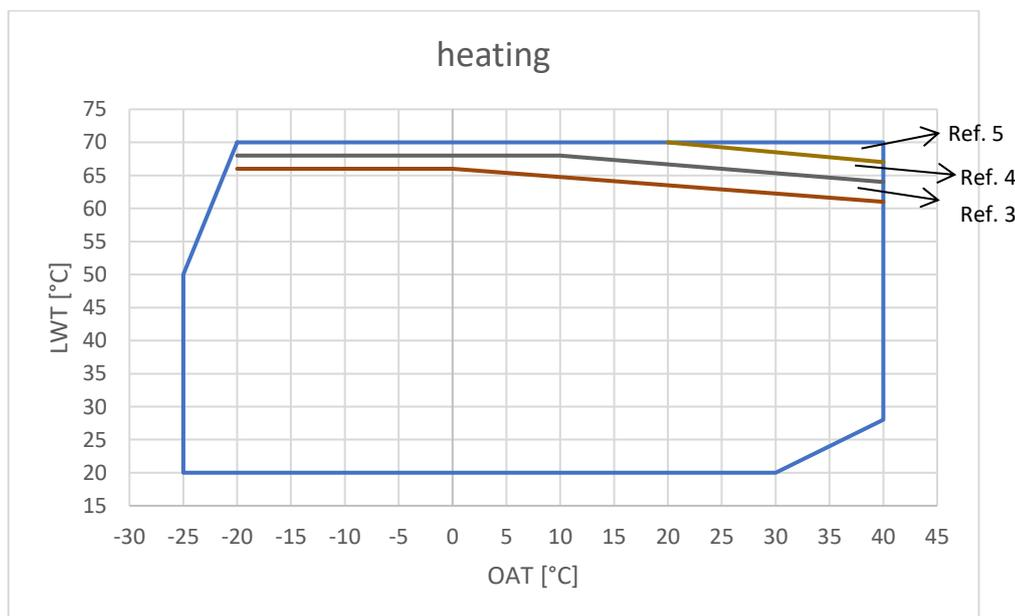
Figura 2 - Limiti operativi EWYE-CZ in modalità riscaldamento
