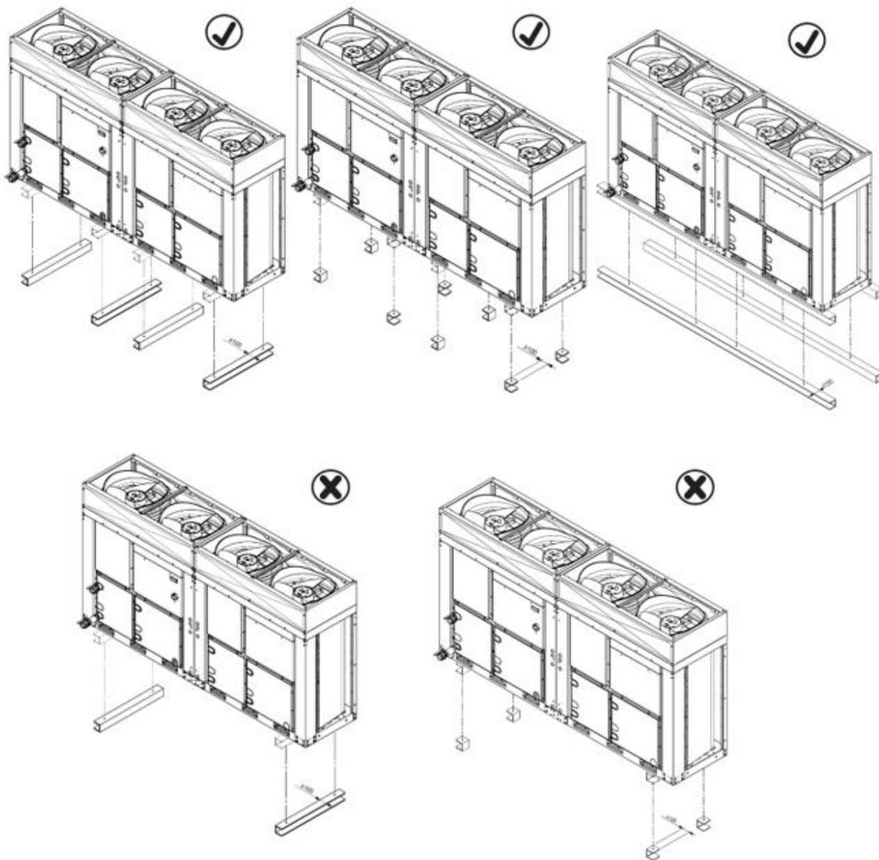
**Figura 6 – Posizionamento unità DUAL**
