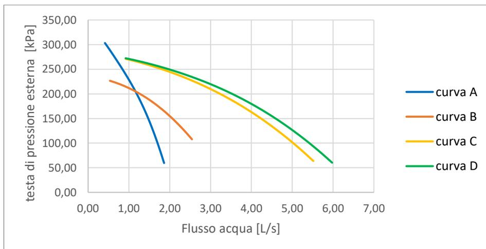
Figura 14 - Prevalenza esterna della pompa ad alzata bassa
