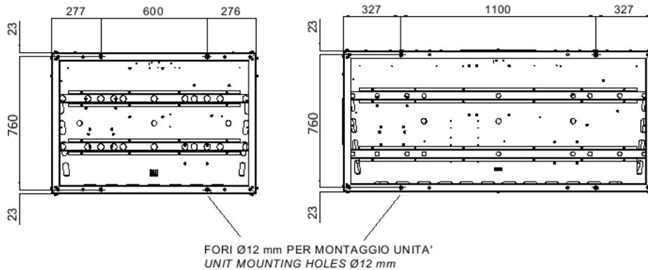
**Abbildung 7 – Anordnung der Montagebohrungen (Ansicht von unten)**
