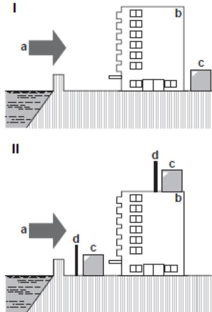
**Abbildung 11 – Installation der Außeneinheit in Meeresnähe**
