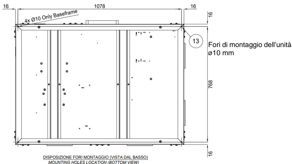
Fissare l'unità in posizione utilizzando quattro bulloni M8 per fondazioni.
