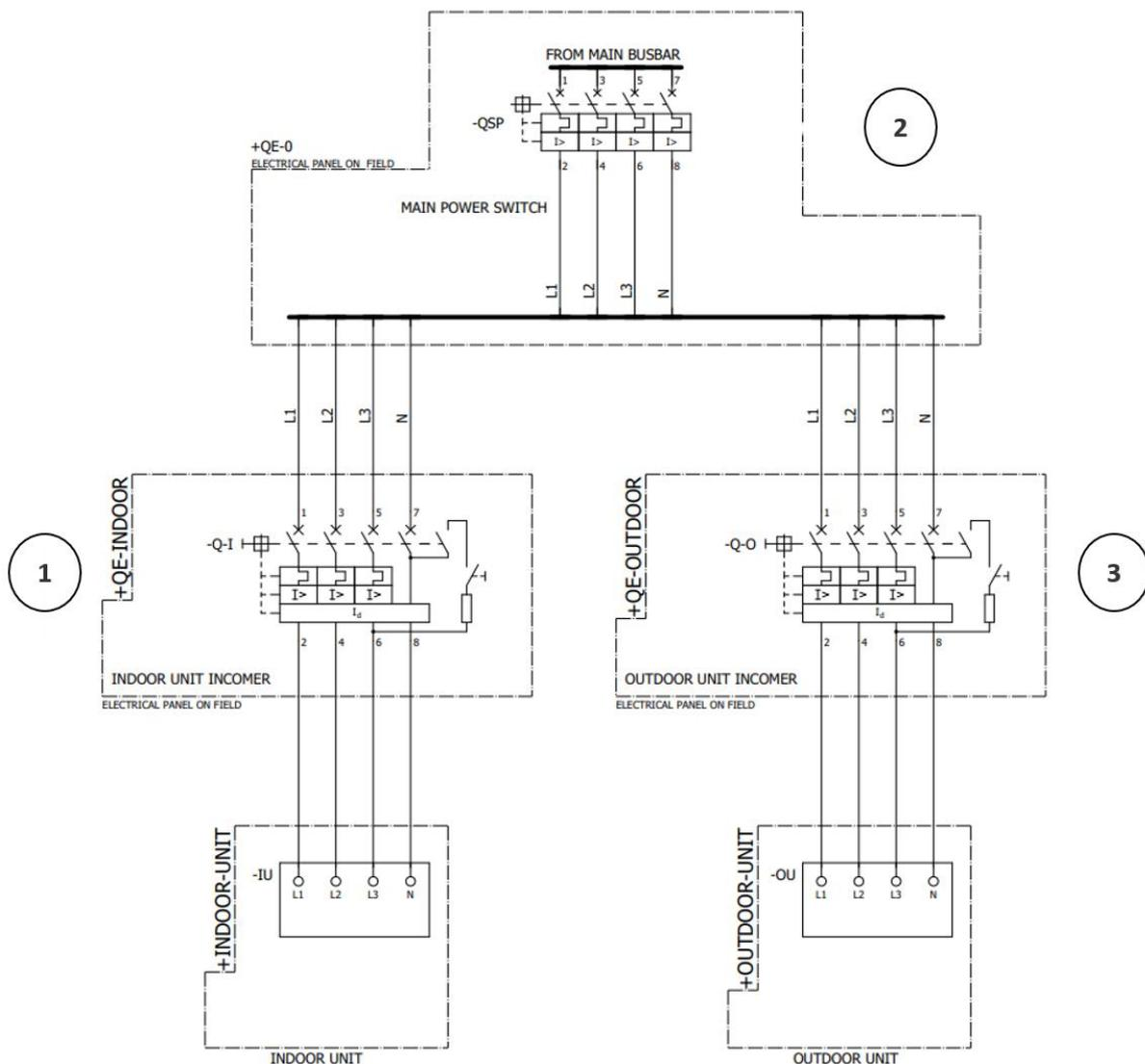
Figura 20 – Schema elettrico principale
