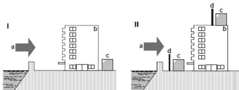
Figura 13 – Installazione sul mare dell'unità esterna
