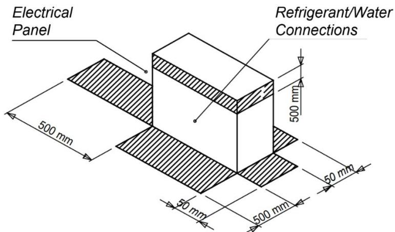
**Figura 12 – Requisiti minimi di spazio per l'unità interna**
