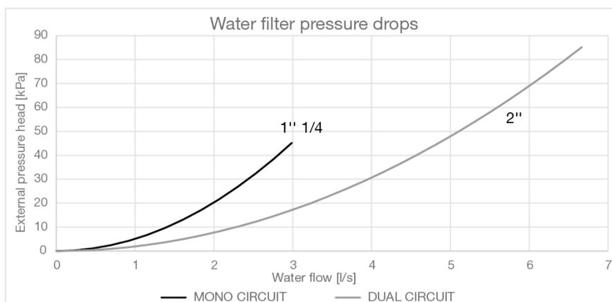
Figura 17 – Cadute di pressione del filtro dell'acqua
