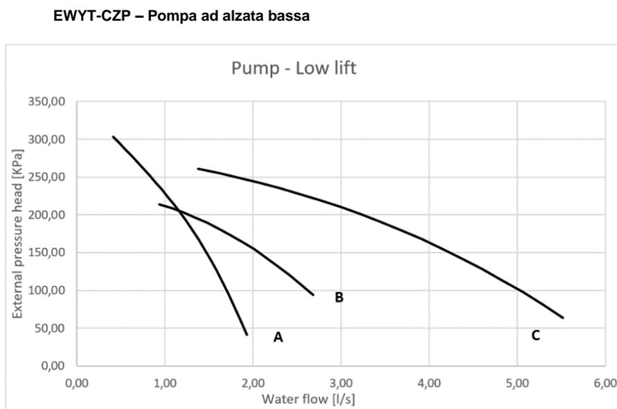
**Figura 18 – Prevalenza esterna della pompa dell'acqua**
