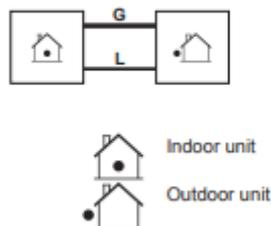
Figura 14 – Schema delle tubazioni unità interna - unità esterna
