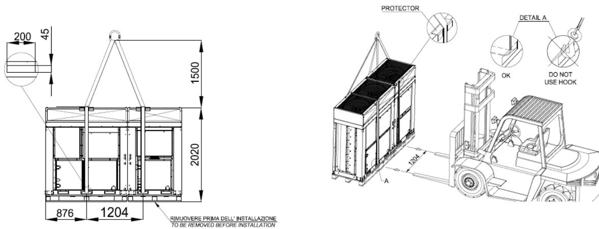
Figura 4 – Elevación de la unidad DOBLE exterior
