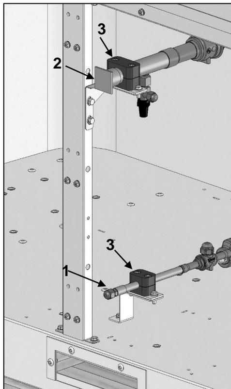
Aquí se muestra detalladamente la tubería externa de la unidad externa, que se debe conectar al sistema de tubería.
