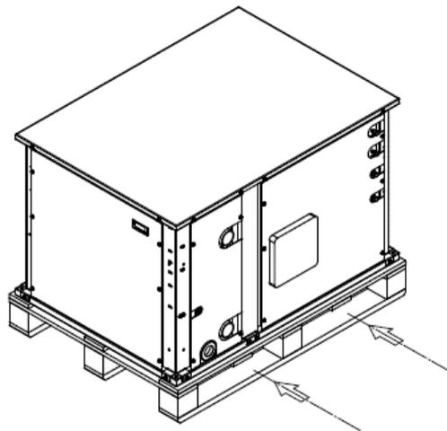
Figura 5 – Manejo y ELEVACIÓN de la unidad interior
