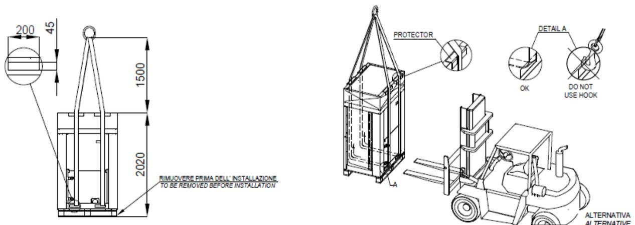
Figura 3 – Elevación de la unidad MONO exterior
