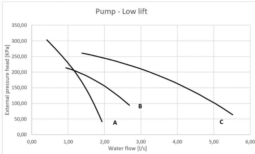
**Figura 18 – Presión externa de bomba de agua**
