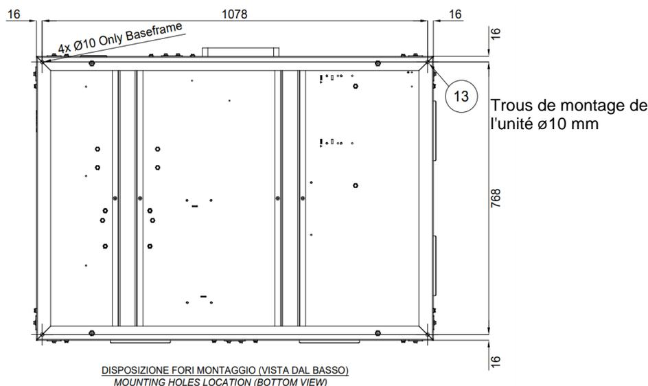
Fixez l'unité en place à l'aide de quatre boulons de fondation M8.
