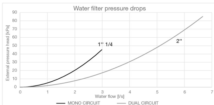
Figure 17 – Pertes de charge du filtre à eau
