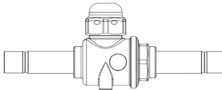
Figure 22 – Clapet à bille
