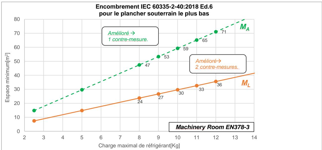
**Tableau 3 – Encombrement : plancher souterrain le plus bas**
