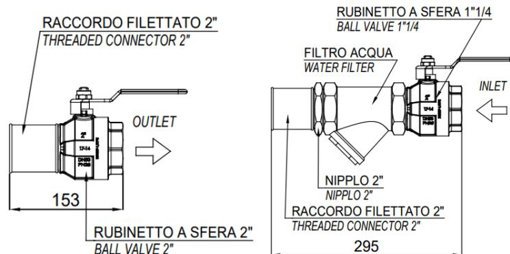
Figure 16 – Éléments hydrauliques
