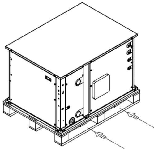
Figure 5 – Manutention et LEVAGE de l'unité intérieure
