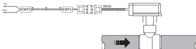
É fornecido um terminal específico na caixa de distribuição para a conexão elétrica do fluxóstato. Consulte o diagrama de cablagem
