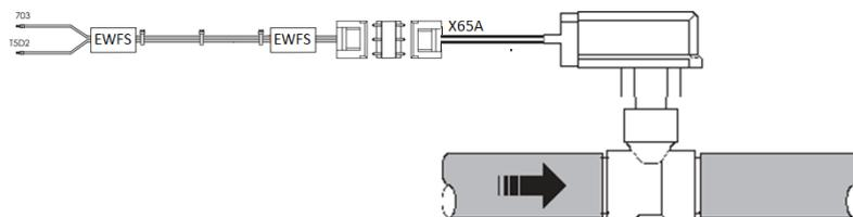
En la caja de conexiones se incluye un terminal donde se conecta el interruptor de flujo. consulte el diagrama de cableado:
