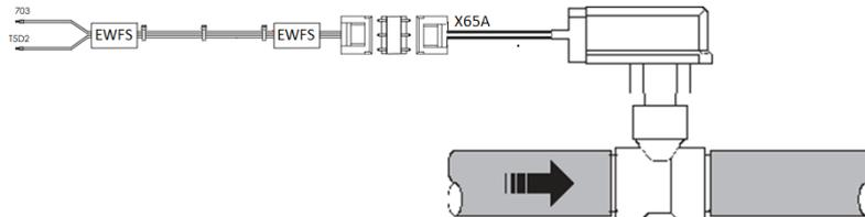
Für den elektrischen Anschluss des Durchflussschalters ist im Schaltkasten eine eigene Klemme vorgesehen. Siehe Schaltplan
