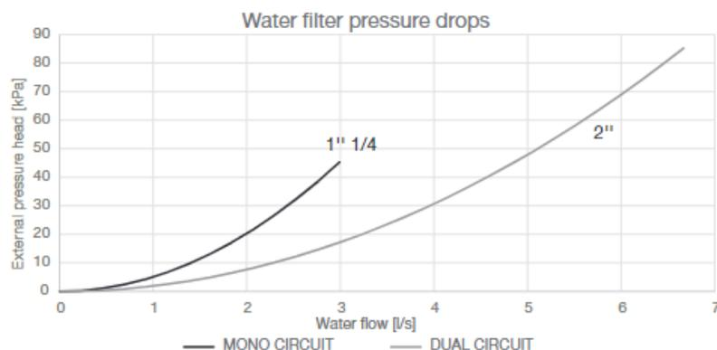
Figura 11 - Perda de carga do filtro de água
