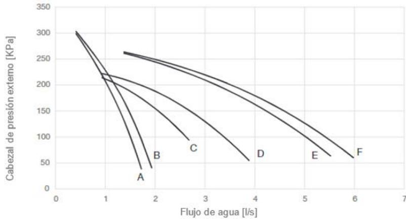
**Figura 12 - Presión externa de bomba de elevación baja**
