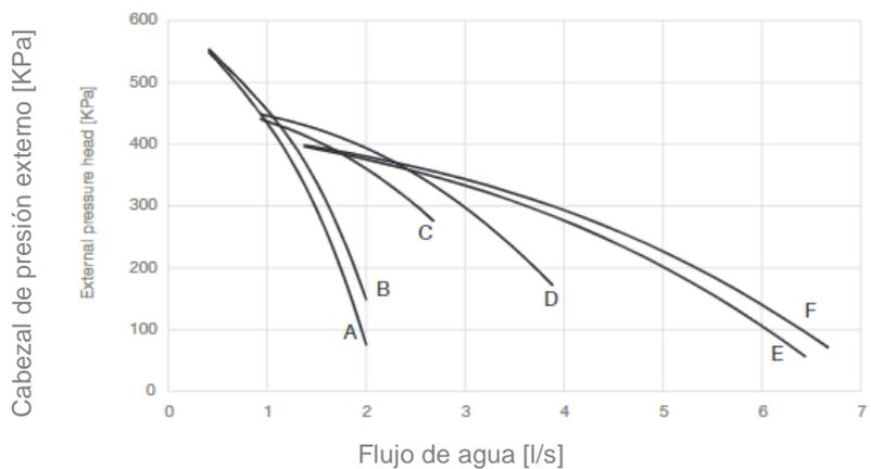
**Figura 13 - Presión externa de bomba de elevación alta**
