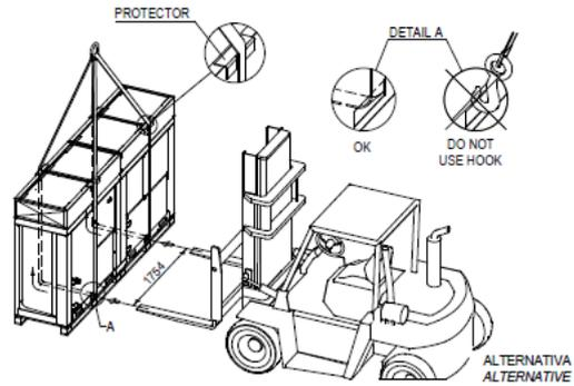
Figura 2 –Elevación de la unidad DOBLE
