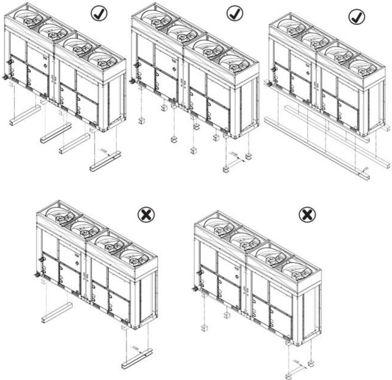
**Figura 4 – Emplazamiento de la unidad DOBLE**
