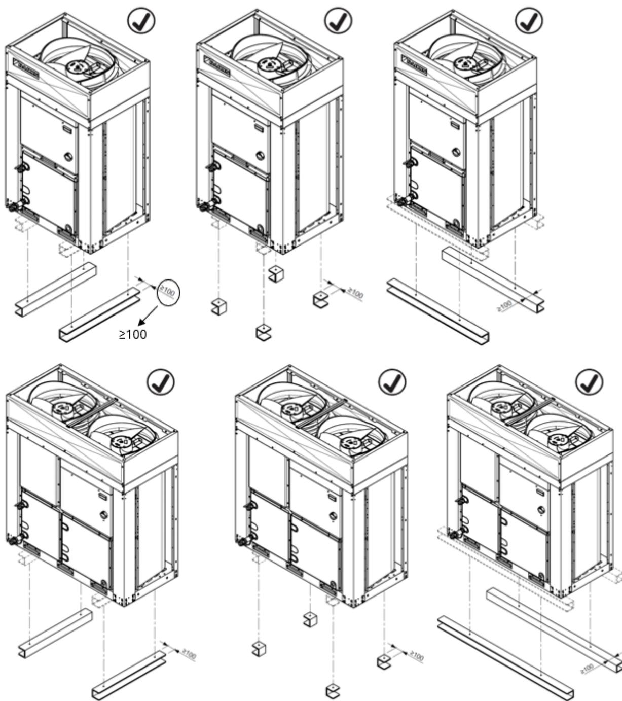
Figura 3 – Emplazamiento de la unidad MONO
