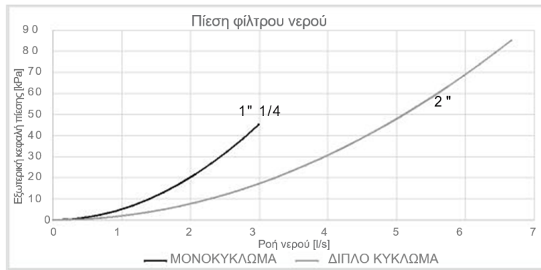
Εικόνα 11 - Πτώσεις πίεσης του φίλτρου νερού
