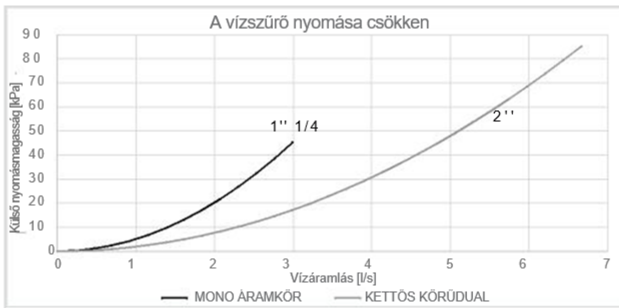
11. ábra - Vízszűrő nyomásesései
