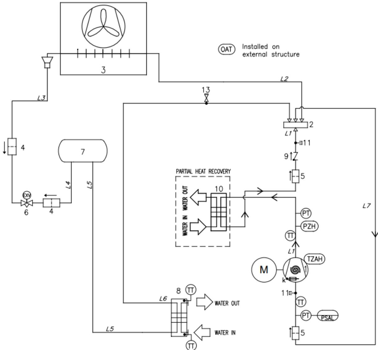
Illustration 18 - Schéma du circuit de réfrigérant (P&ID) pour circuit MONO unité EWYT~CZ
