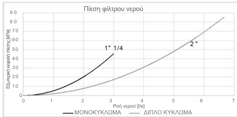
Εικόνα 11 - Πτώσεις πίεσης του φίλτρου νερού
