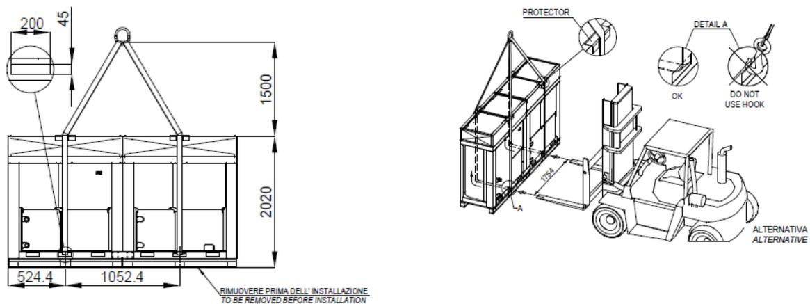
Abbildung 2 – Anheben der DUAL-Einheit
