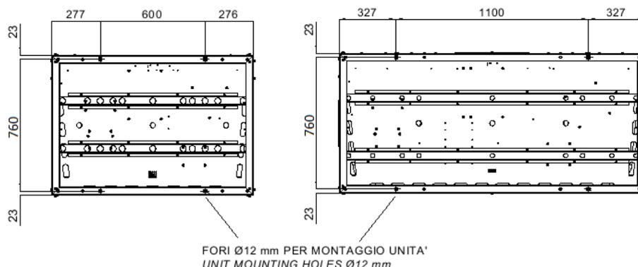
**Abbildung 5 – Anordnung der Montagebohrungen (Ansicht von unten)**
