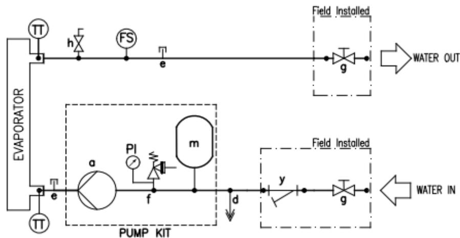
Abbildung 10 – Hydraulikschema
