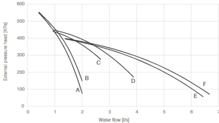
**Abbildung 13 - Externe Druckhöhe einer Pumpe mit hoher Förderhöhe**
