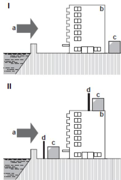
**Abbildung 9 – Installation der Außeneinheit in Meeresnähe**
