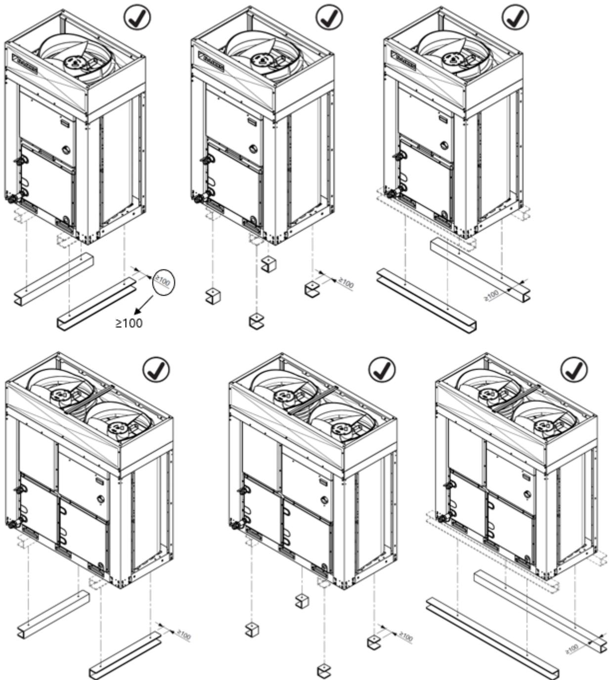
Abbildung 3 – Positionierung MONO-Gerät
