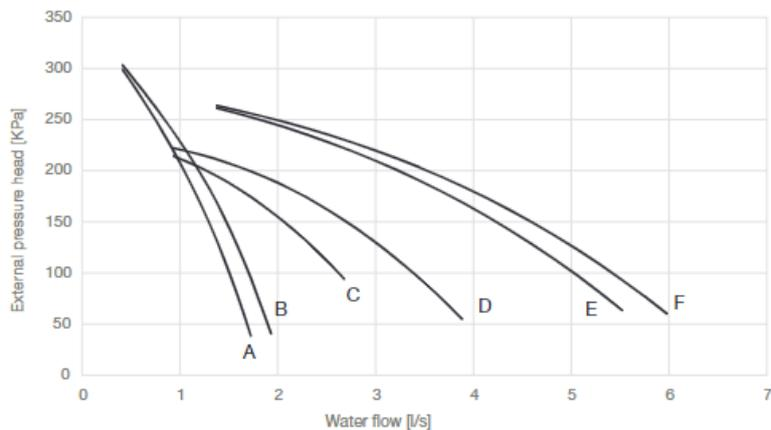
Abbildung 12 - Externe Druckhöhe einer Pumpe mit geringer Förderhöhe
