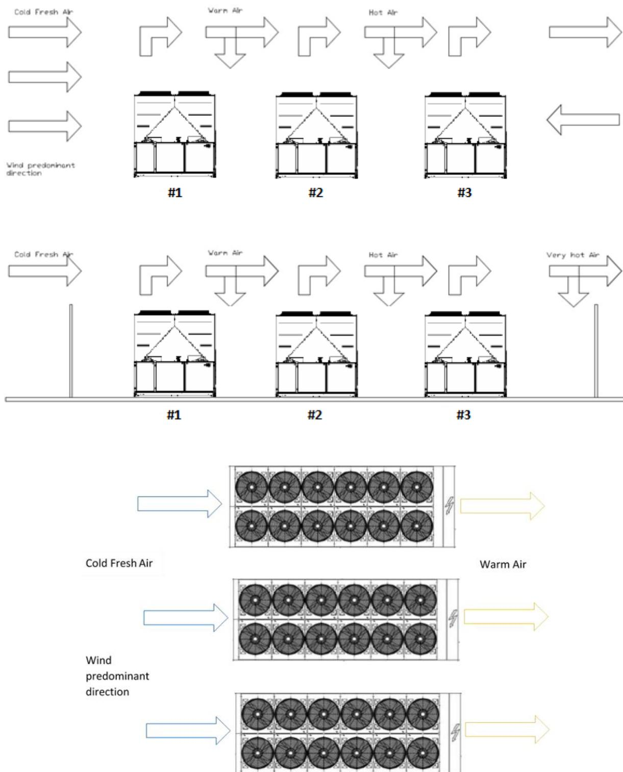
**Fig. 12 – Instalação de várias unidades (modo de refrigeração)**
