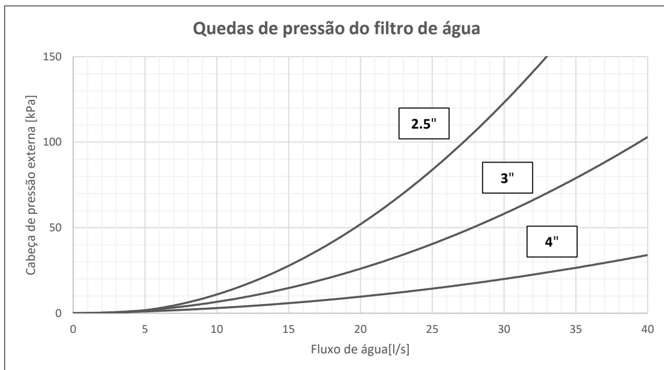
Fig. 13 – Queda de pressão no filtro de água
