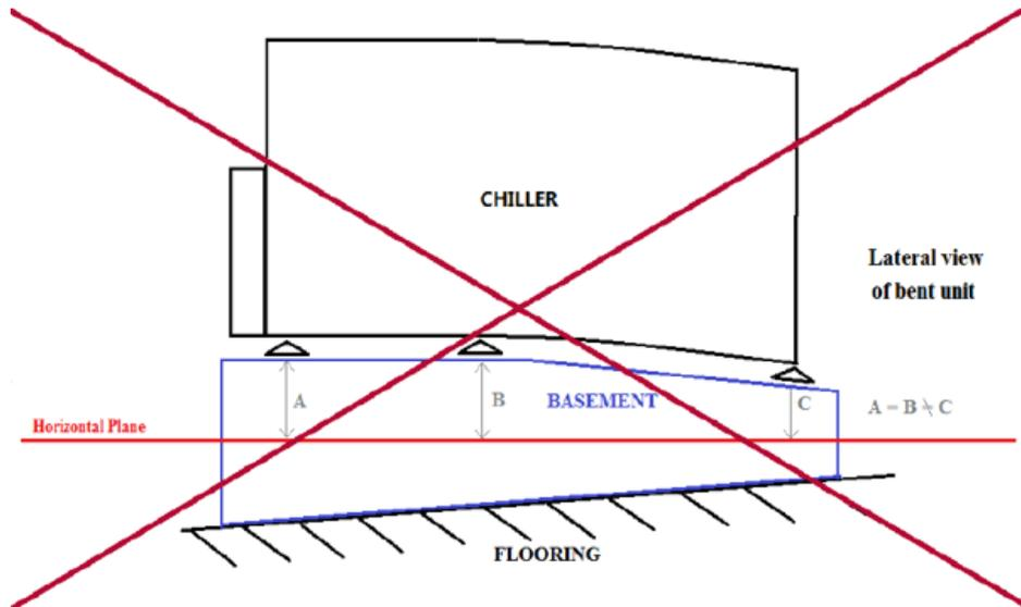
Fig. 10 – Nivelamento da unidade
