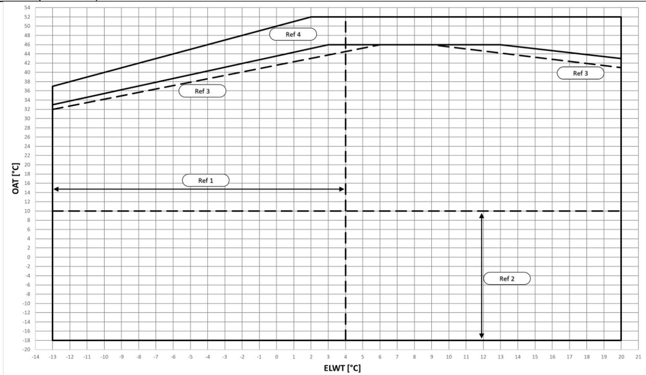
**Fig. 3 – Limites operativos do modo de refrigeração EWYTx0B-S**
