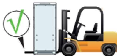
Levante a unidade com os garfos apoiados na parte inferior, não nos suportes dos pés
