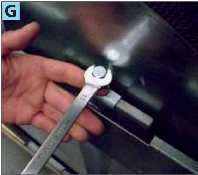
3) Regolare le convergenza della ruota tramite la vite 2 (foto G)
