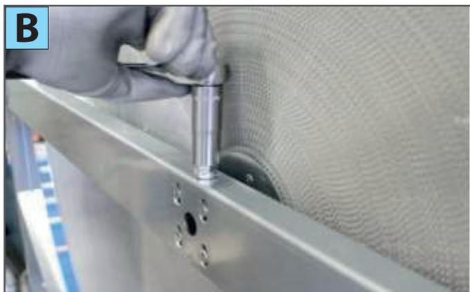
2) Regolare la convergenza della ruota usando un bullone verticale (foto B)
