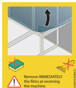
Verwijdering plasticfolie van bovenkant
