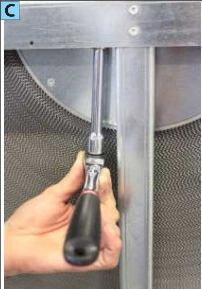
1) Draai de twee schroeven los (foto C)
