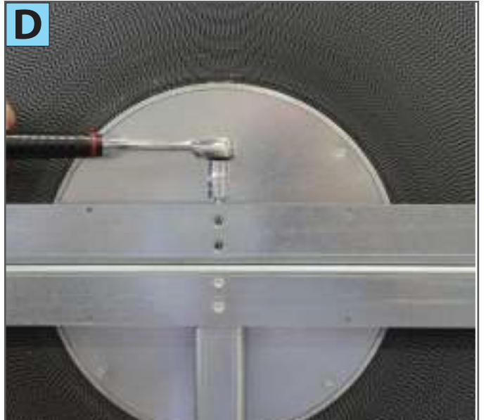
2) Stel het toespoor van het wiel af met de verticale schroef (foto D)
