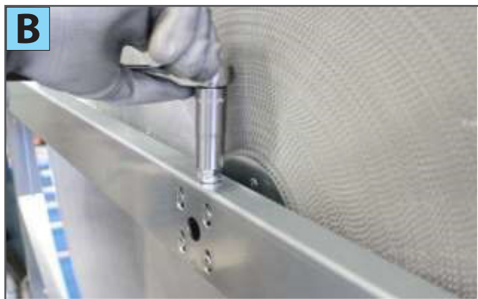
2) Ajuste la convergencia de la rueda con el perno vertical (foto B).
