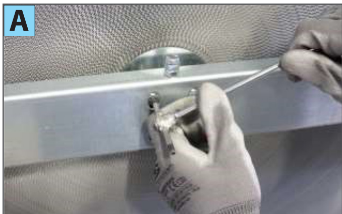
1) Afloje los 4 tornillos (foto A)
