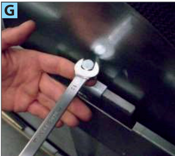
3) Upravte sbíhavost kola pomocí šroubu 2 (foto G)
