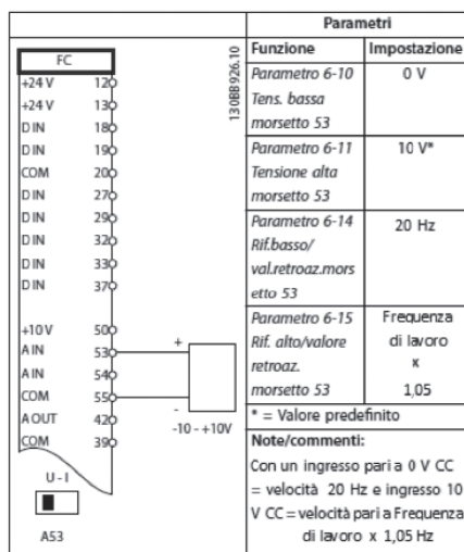
Elektroinstalace pro kontrolu rychlosti otevřené smyčky
