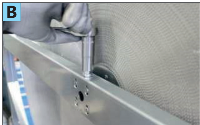
2) Upravte sbíhavost kola pomocí vertikálního šroubu (foto B)
