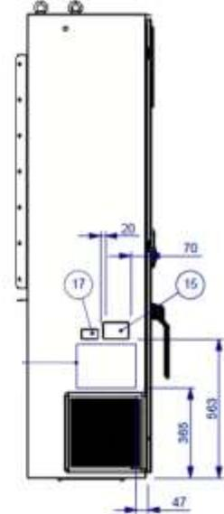
الشكل 17 - وصف للمصقات الموجودة على اللوحة الكهربائية الكبيرة.
