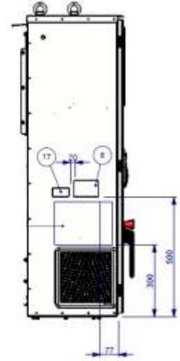
الشكل 16 - وصف للمصقات الموجودة على اللوحة الكهربائية المتوسطة.
