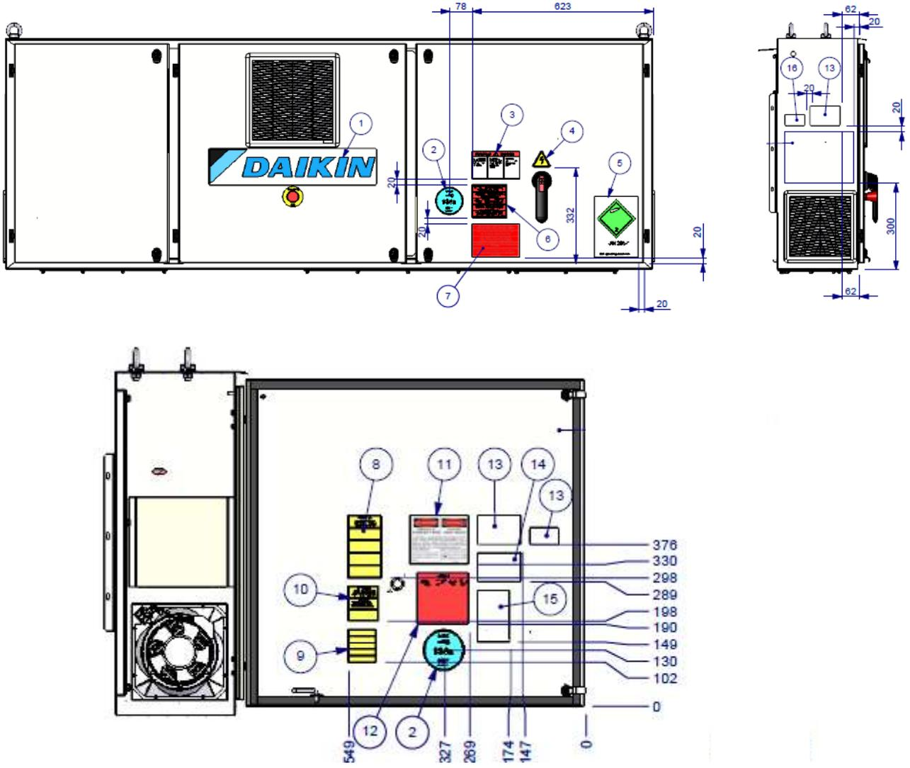
الشكل 15 - وصف للملصقات الموجودة على اللوحة الكهربائية الصغيرة
