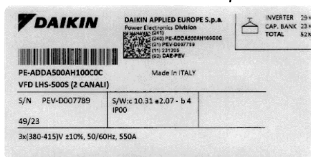
Kuva 31 – VFD LHS laitekilpi
