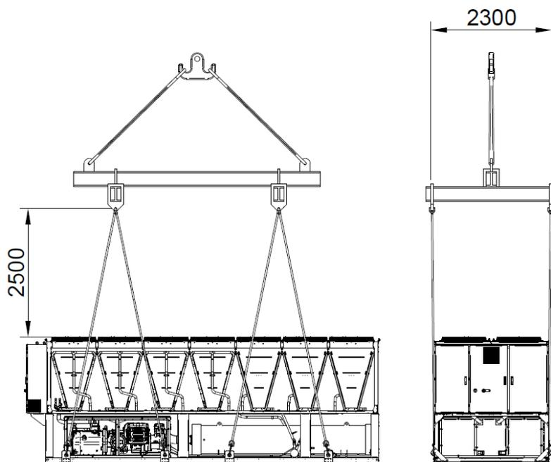
Рисунок 4- Выравнивание агрегата
