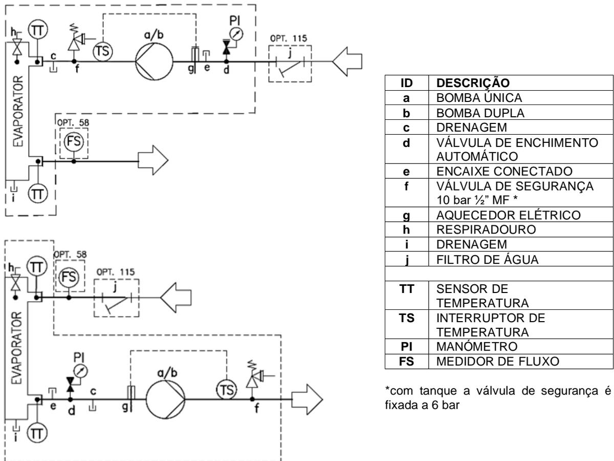
Figura 8 - Ligações da tubagem de água para os permutadores do recuperador de calor
