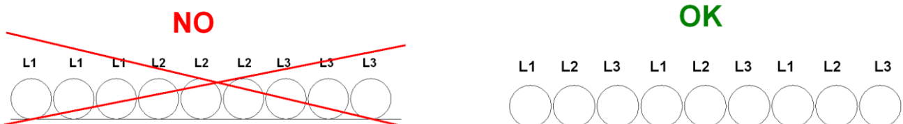
Figur 17 – Installation av långa matningsledningar
