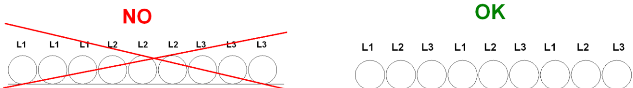
Figura 17 – Montarea cablurilor de alimentare lungi
