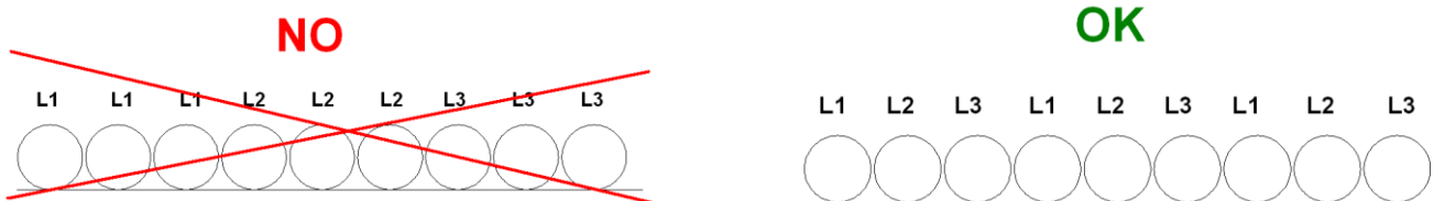
Figura 17 - Instalação de cabos de fornecimento eléctrico compridos
