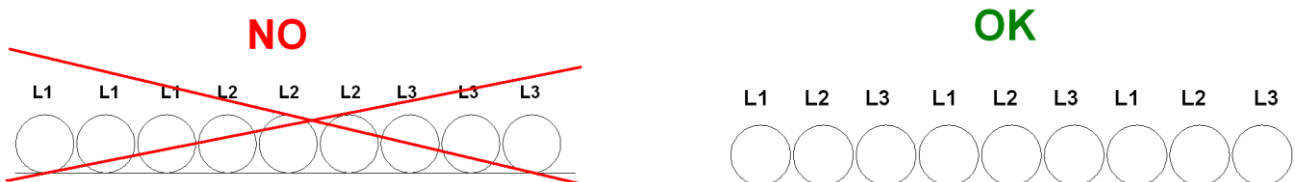
Afbeelding 17 - Installatie van lange voedingskabels
