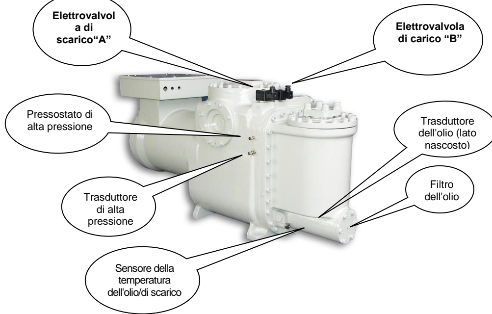
Figura 32 – Installazione dei dispositivi di controllo per il compressore Fr3100
