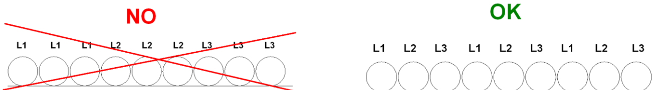
17.ábra - Hosszú tápvezetékek beszerelése
