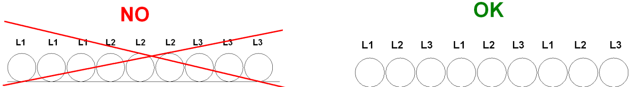
Figure 17 - Installation du câblage d'alimentation
