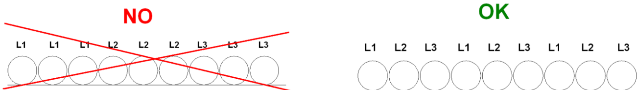
Figura 17 - Instalación de cables largos de energía
