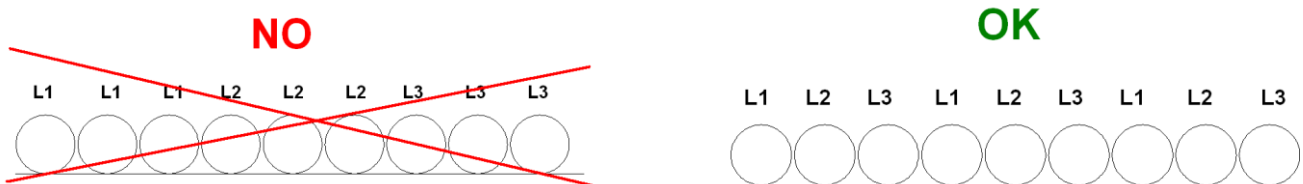
Obrázek 17 - Instalace dlouhých napájecích vodičů
