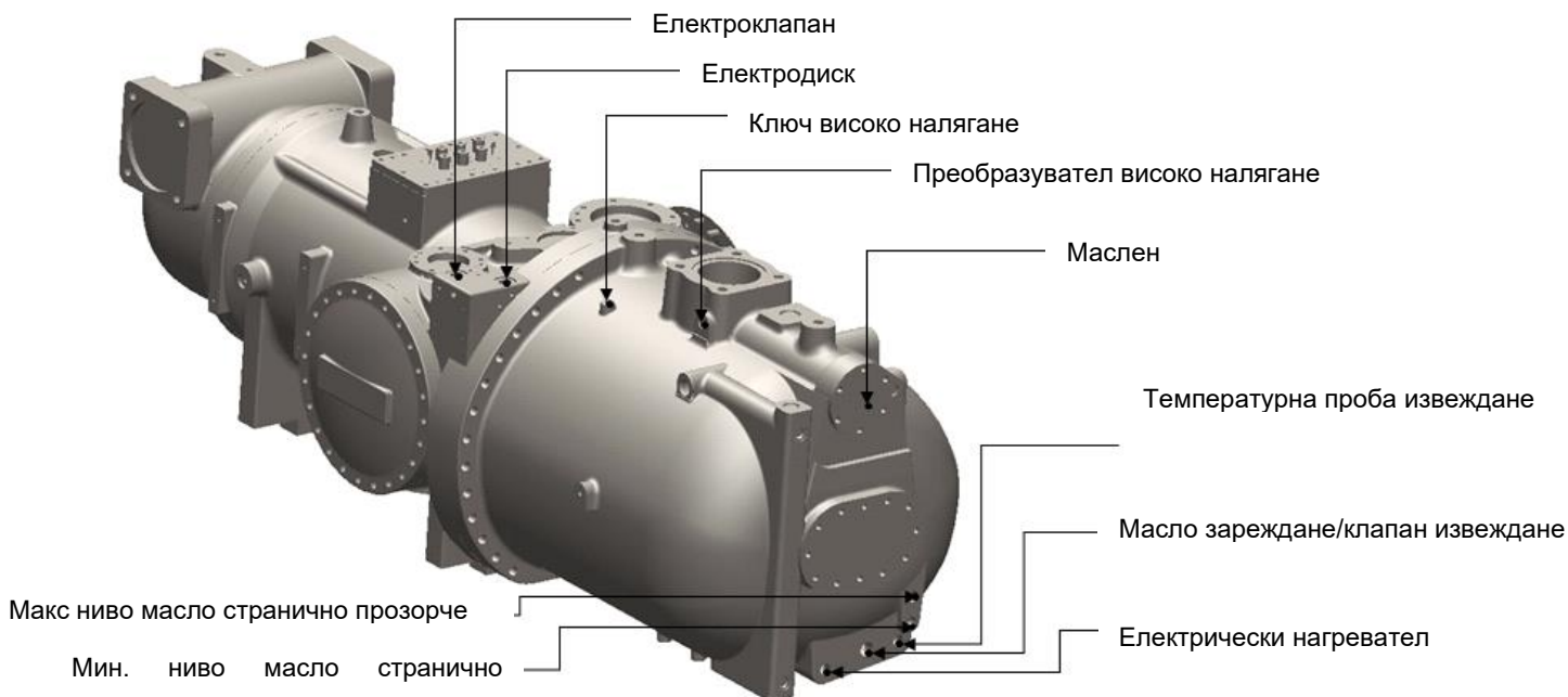
Схема 33 - Монтиране контролни уреди за Fr3 компресор
