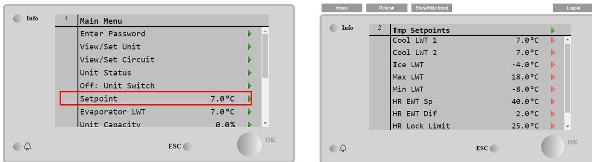
La unidad puede funcionar con un punto de ajuste primario o secundario, los cuales pueden gestionarse como se indica a continuación:
