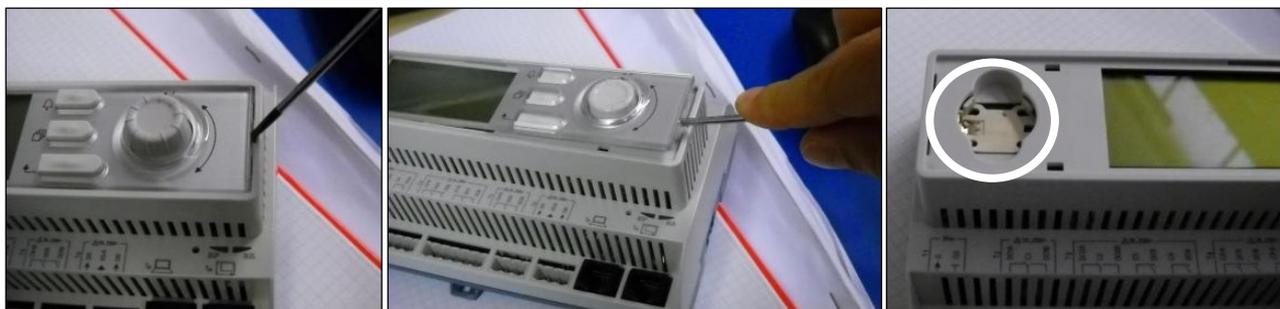
Tenha cuidado para evitar danos à cobertura de plástico. A nova bateria deve ser colocada no suporte apropriado da bateria, destacado na figura, respeitando as polaridades indicadas no próprio suporte.
