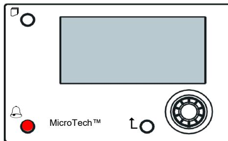
L'IHM à commande distante peut couvrir un rayon de 700 m en utilisant la connexion de bus de processus disponible sur le régulateur de l'unité. Une connexion en guirlande comme indiquée ci-dessous permet de connecter jusqu'à 8 unités à une seule IHM. Pour plus d'informations, veuillez consulter le manuel spécifique de l'IHM.
