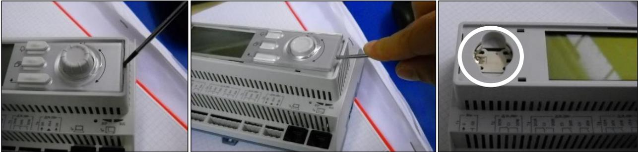
Veiller à ne pas endommager le couvercle en plastique. La nouvelle batterie peut être placée dans le support de batterie prévu à cet effet (surligné dans la photo ci-dessous) en respectant les polarités indiquées sur le support.
