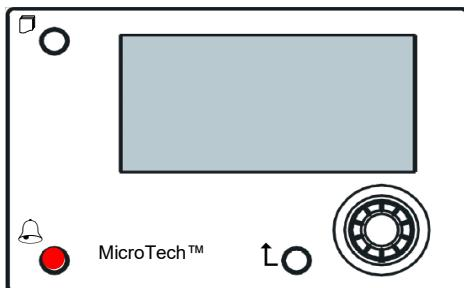
Vzdálené HMI lze použít až na 700 m, pomocí propojení svorkovnice dostupné na UC. Při řetězovém zapojení popsaném níže lze jedno HMI propojit až s 8 zařízeními. Podrobnosti viz konkrétní návod k použití HMI.
