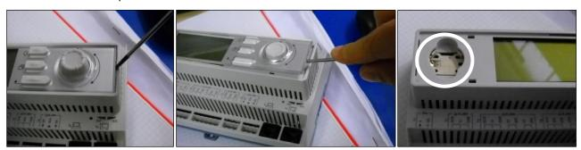
Veiller à ne pas endommager le couvercle en plastique. La nouvelle batterie peut être placée dans le support de batterie prévu à cet effet (surligné dans la photo ci-dessous) en respectant les polarités indiquées sur le support.
