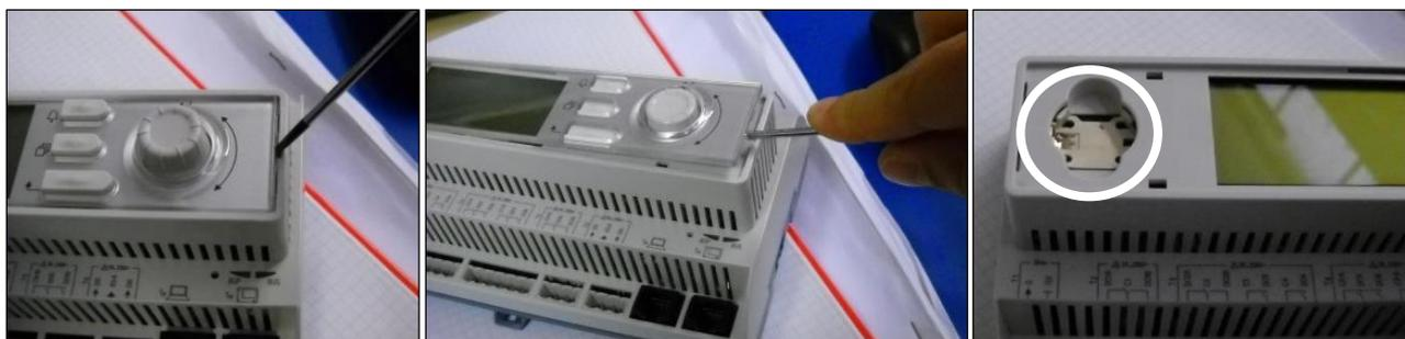
Seien Sie vorsichtig, damit die Kunststoffabdeckung nicht beschädigt wird. Dann die neue Batterie ordnungsgemäß in die Halterung - siehe den markierten Bereich im nachfolgenden Bild - einsetzen und dabei auf die richtige Polarität achten, so wie sie in der Halterung gekennzeichnet ist.
